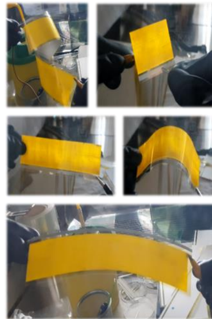
Εικόνα 2. Εύκαμπτες Διατάξεις OLED, οι οποίες κατασκευάστηκαν στο Εργαστήριο Νανοτεχνολογίας LTFN στα πλαίσια του ερευνητικού έργου «APOLLON» .
