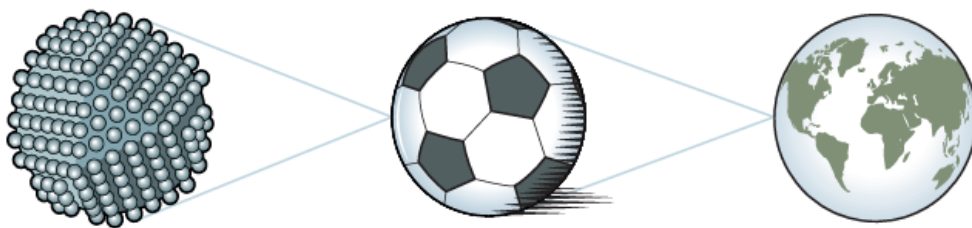
Σχήμα 1: Μία κβαντική τελεία αποτελείται από μερικές χιλιάδες άτομα. Σε όρους μεγέθους, έχει την ίδια σχέση μεγέθους με την μπάλα ποδοσφαίρου, όση εκείνη που έχει η μπάλα ποδοσφαίρου με τη Γη.
